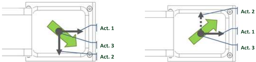
図 5-1: Asycube 50&80 – アクチュエータの配置と例 (緑の矢印)(実線:0° 位相、点線:180° 位相)
