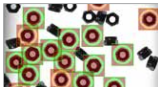
衝突回避のため、グリッパの形状と除外領域を規定
