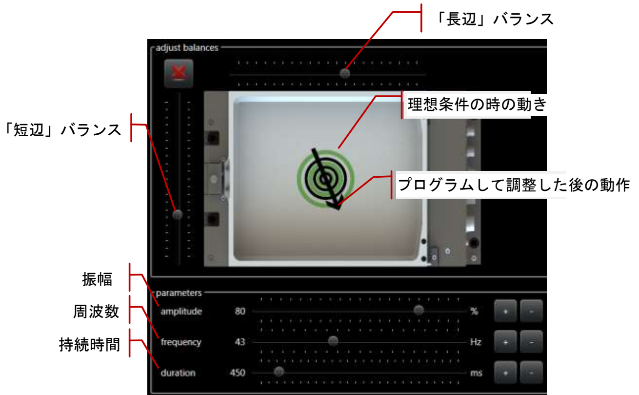
図 5-3: Asycube 240、380、530 HMI の EASY チューニング
